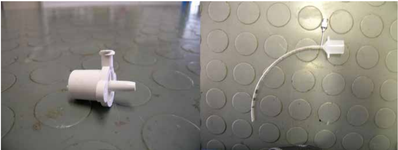
Fig.6: raccordi per il corretto posizionamento della linea di campionamento di un capnografo con sistema sidestream. Per limitare gli artefatti nei pazienti di piccole dimensioni è opportuno avvicinare quanto più possibile il punto di campionamento al termine del tracheotubo.
