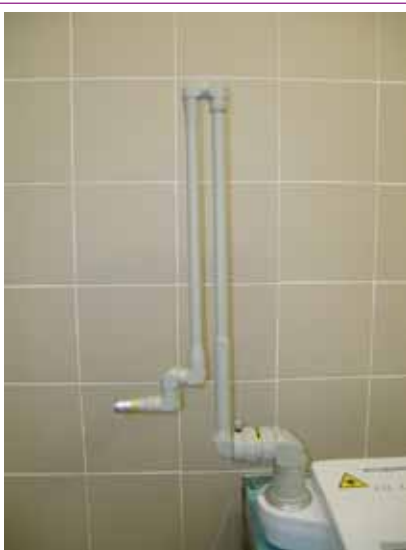
Fig. 11. Apparecchio laser CO 2 : braccio articolato
